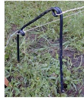
✓ piquets à double montant incliné en « U renversé » conseillés pour les clôtures électriques contre le sanglier : pose et dépose aisées, meilleure efficacité, supports sans tendeurs
