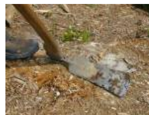
Pioche longue et étroite pour bien fouiller le sol en profondeur
