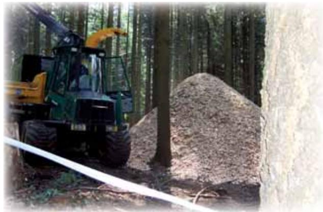
Transformation en plaquettes des arbres délivrés dans les cloisonnements ou issus d'éclaircies sélectives
