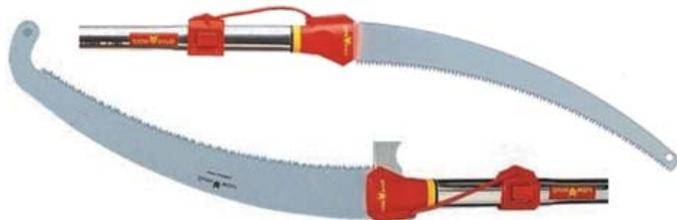
Les modèles les plus perfectionnés possèdent une butée en tête de lame (ou crochet avant) pour arrêter la scie dans le trait de coupe ainsi qu'un couteau d'appoint à sa base permettant l'entaille du dessous de la branche afin d'éviter son arrachement en fin de coupe. Les modèles à lame relativement étroite et arquée, plus maniables entre les branches sont à préférer aux scies montées sur cadre, plus puissantes mais trop encombrantes.
